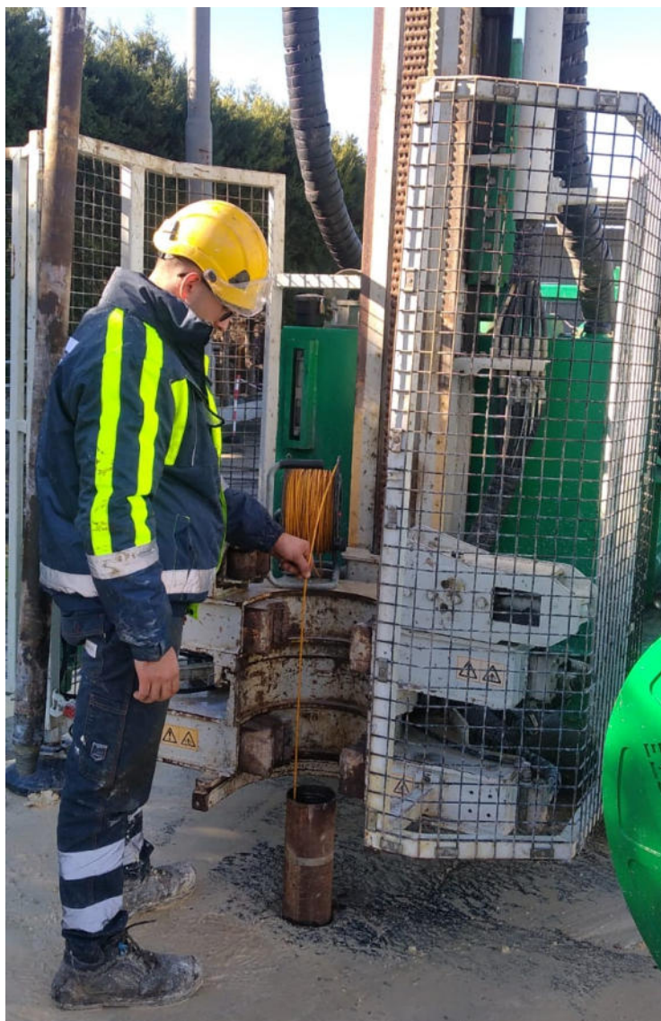
Foto 5-Prova di permeabilità Le Franc
